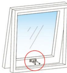
**3 Determine la posición del soporte de montaje de acuerdo con la posición del conector de la ventana, utilice cuatro tornillos autorroscantes de cabeza redonda Ø5 para fijar el soporte de montaje en forma de U. Cuando instale el soporte de montaje lateral en forma de L, utilice cinco tornillos autorroscantes de cabeza redonda de Ø5 para fijarlo, como se muestra en la figura 3.**
